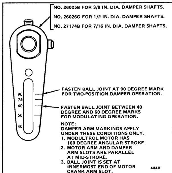
**FIG. 11—POSITION BALL JOINT ON DAMPER CRANK ARM.**
